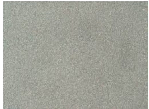
Фигура 2 – Почистен метал клас Sa2.5
