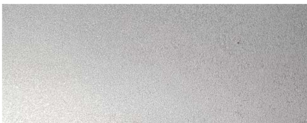
Фигура 2 – Почистен метал клас Sa2.5
