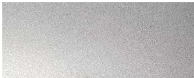
Фигура 2 – Почистен метал клас Sa2.5
