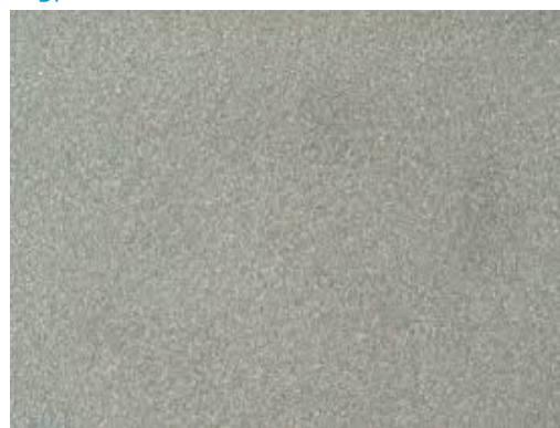
Фигура 2 – Почистен метал клас Sa2.5
